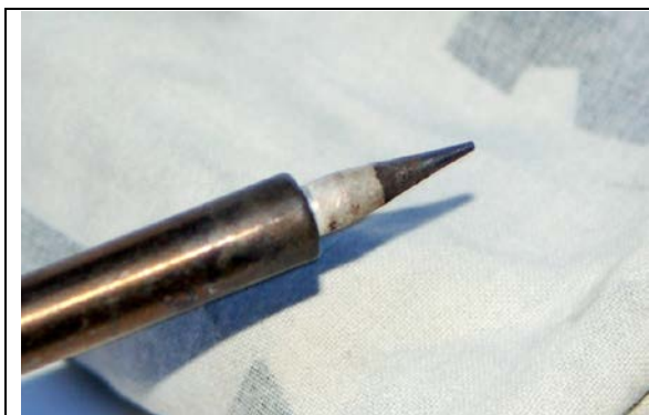
Gebruik altijd een schone soldeerbout. Een warme soldeerbout veegt men helemaal proper met een (eventueel licht vochtige) vod.
