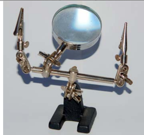
Zorg dat de te solderen verbindingen kunnen gestabiliseerd worden. Gebruik daarvoor eventueel een zogenaamde “derde hand” die je voor enkele euro's op de kop kan tikken.
